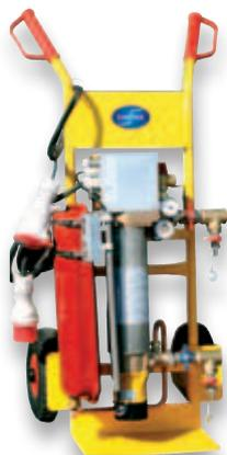
Riscaldatore elettrico completo di pompa e centralina di regolazione (stazione mobile specifica per scaldare l'impianto a pavimento con l'energia elettrica di cantiere, per l'asciugatura del massetto, prima di installare il generatore di calore):
