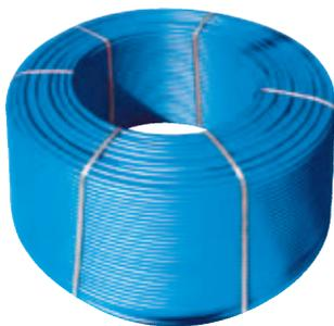
Tubo trasduttore specifico per impianti radianti (UNI EN 22391-UNI EN 1264.4.2); sicurezza di controllo continuo del tubo; impianto protetto dalla corrosione con Barriera ossigeno DIN 4726; densità polimero: 0,94 g/cm<sup>3</sup> - ISO 1183; tubo di alta morbidezza garantita nel tempo per impianti radianti.
