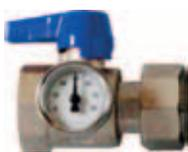
Valvola a sfera blu con termometro, specifica per collettore AISI; corpo in ottone nichelato; F1" x F1" con dado girevole per il facile montaggio in cantiere.
