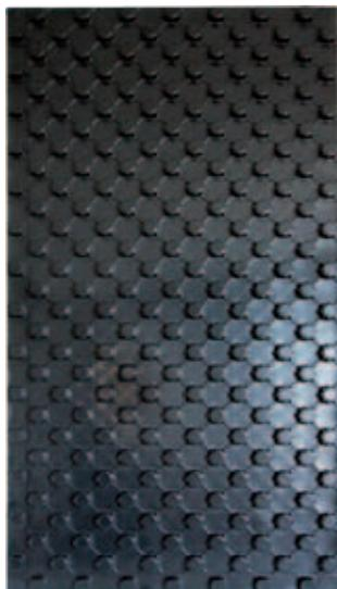
Specifico per impianti radianti con spessori sottili, stampato in EPS 200 vergine 100% con marchio CE (EN 13163); conducibilità termica  $\lambda_D=0,034$  W/mK (EN 12667); carico utile garantito nel tempo (EN 1606); classe di reazione al fuoco Euroclasse E (pannello) ed F (rivestimento).
