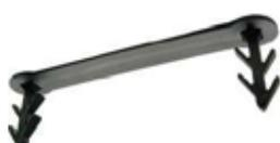
Clip ad uso manuale per rifiniture sui pannelli bugnati. Specifica per EvoFlex. Per meglio fissare il tubo o la rete allo strato isolante di polistirolo espanso. In polipropilene nero. Lunghezza: 90 x altezza 28 mm.
