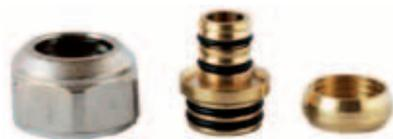
Raccordo a compressione in tre unità, per connessioni fra collettore e tubo. Con due O-ring lato tubo, due O-ring lato collettore e dielettrico in testa al tubo. Utilizzabile sia per tubo sintetico che multistrato.
