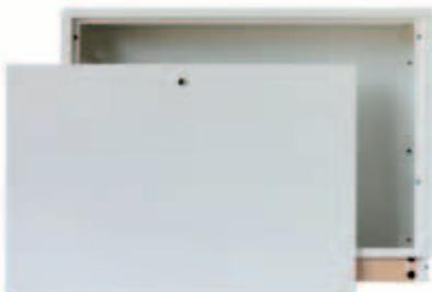
Cassetta universale per EVOKAL, AISI ed EVOMIX (spessore 10,5 cm espandibile fino a 16 cm); altezza netta con cornice 55 cm, altezza netta in fase cantiere (senza cornice) 57 cm e altezza totale 75 cm. Completamente verniciata (interno, cornice e portina verniciate a polveri); piedini regolabili in altezza; coperchio paramalta per la protezione nella fase di intonacatura; chiusura a chiavetta; cornice registrabile rispetto al telaio, secondo brev. dep. MI2004U000056.
