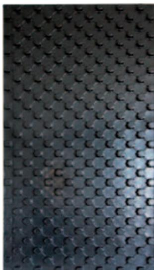
Specifico per impianto radiante, stampato in EPS 150 vergine 100%: con marchio CE (EN 13163); conducibilità termica  $\lambda_D=0,035$  W/mK (EN 12667); carico utile garantito nel tempo (EN 1606); classe di reazione al fuoco Euroclasse E (pannello) ed F (rivestimento).
