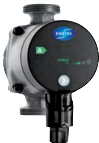
Circolatore in classe di efficienza energetica "A", con magnete permanente e convertitore di frequenza, IP 42, classe di isolamento F, G 1"1/2, int 130 mm, voltaggio 1x230 V.
