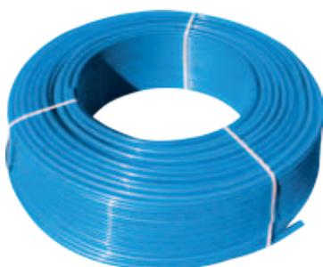
Tubo multistrato morbido per impianti radianti secondo EN 1264. Prodotto secondo la normativa EN 21003. È composto da un tubo interno di PoliEtilene Resistente Termicamente, da uno intermedio in alluminio morbido da 0,2 mm di spessore, saldato di testa a laser e da un tubo esterno in polietilene ad alta densità PE-HD, stabilizzato ai raggi UV. Sicurezza assoluta di tenuta dell'ossigeno.
