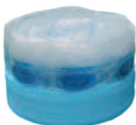
Striscia perimetrale specifica per impianti radianti. Va disposta obbligatoriamente lungo tutto il perimetro dei locali da riscaldare al fine di compensare gli eventuali assestamenti del massetto. In polietilene espanso, adesivo per ottimale applicazione 6x150 mm. Sbordo in PE.LD (lunghezza 230 mm) da risvoltare sopra i pannelli.
