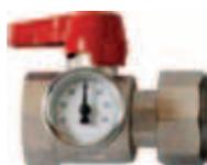
Valvola a sfera rossa con termometro, specifica per collettore AISI; corpo in ottone nichelato; F1" x F1" con dado girevole per il facile montaggio in cantiere.
