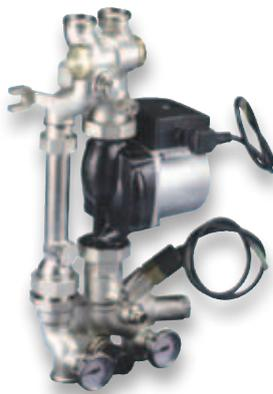
Modulo di miscelazione per impianti radianti, completo di valvola miscelatrice assiale a 3 vie, by-pass secondario con doppia regolazione micrometrica e memoria di posizione, valvole a sfera per intercettazione pompa, valvola di non ritorno, by-pass differenziale di sovrappressione 0,2-0,6 bar, termostato di sicurezza a 60 °C.
