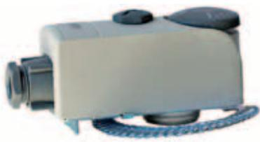
Termostato a contatto, di ingombro limitato, con molla di fissaggio. Lunghezza 230 mm. Adatto per tubi fino a 2". Campo di regolazione da 30 a 90 °C. Differenziale a 20°C < 10 K, portata contatti 16 (x 4) A. Alimentazione 230 V ca, IP 40.
