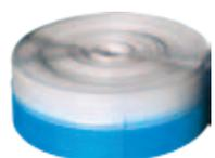
Striscia perimetrale specifica per impianti radianti. Va disposta obbligatoriamente lungo tutto il perimetro dei locali da riscaldare al fine di compensare gli eventuali assestamenti del massetto. In polietilene espanso, adesivo per ottimale applicazione 6x150 mm. Sbordo in PE Espanso di 90 mm da posare sotto il pannello.
