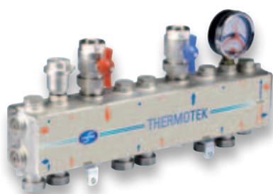
Collettore in ottone fuso CB753S, conforme UNI EN 1982-00, con by-pass integrato regolabile ed intercettabile per separare idraulicamente il circuito primario dal secondario, bocchettoni, valvole a sfera DN 25, termomanometro 0-6 bar/0-120 °C e valvola automatica di sfiato aria.
