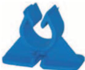
Clip a calice per il fissaggio del tubo sulla rete metallica da Ø 3 e da 5 mm. Realizzata con specifici piedini per sollevare la rete dal fondo di 7 mm (all'asse). Altezza di appoggio del tubo: 12 mm altezza totale. Clip: 36 mm, per tubi trasduttori Ø 15-18.
