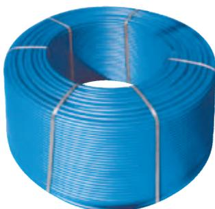
Tubo trasduttore specifico per impianti radianti (UNI EN 1264.4.2); tubo estruso reticolato ai silani (UNI EN ISO 15875); sicurezza di controllo continuo del tubo; impianto protetto dalla corrosione con Barriera ossigeno DIN 4726; polimero alta densità: 0,95 g/cm<sup>3</sup> - ISO 1183; tubo reticolato in classe A di alta Qualità per impianto radiante.
