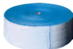
Striscia perimetrale specifica per impianti radianti. Va disposta obbligatoriamente lungo tutto il perimetro degli ambienti da riscaldare al fine di compensare gli eventuali assestamenti del massetto industriale. In polietilene espanso, con adesivo per ottimale applicazione ai muri e pilastri 8-10x250 mm.
