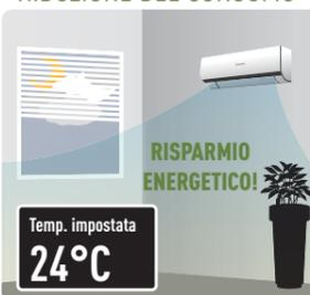
Riduce la potenza di raffrescamento di un livello equivalente a un aumento della temperatura ambiente di 1 °C.
