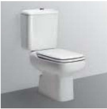
Vaso a cacciata per cassetta appoggiata con scarico (6 litri) a pavimento o a parete. Presa acqua per alimentazione cassetta: 250 mm da pavimento finito.
