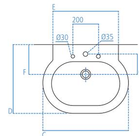
Lavabo da semincasso con foro per la rubinetteria centrale aperto e laterali diaframmati, vi si possono installare sia rubinetti monoforo che a tre fori. La dima e il fissaggio a parete sono a corredo.
