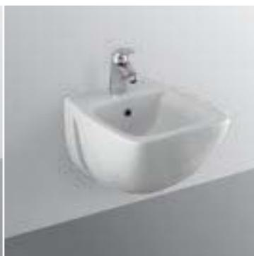
Bidet sospeso monoforo con erogazione dell'acqua dal rubinetto, vi si possono installare sia rubinetti monocomando che monoforo a doppio comando. Per il fissaggio a parete è necessario utilizzare l'apposito sostegno metallico da incasso.
