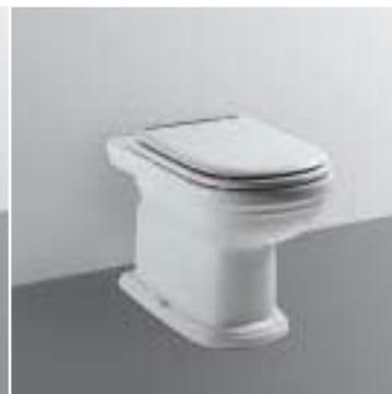
Vaso a cacciata con scarico a pavimento o a parete. Funziona con passo rapido e flussometro portata 1,2 l/sec - cassetta alta (scarico 9 l in 6 sec) o immurata (scarico 6 l in 4 sec). Il vaso è corredato di sedile.
