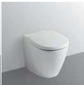
Vaso a terra filo parete, funziona con passo rapido e flussometro portata 1,2/l sec cassetta alta (scarico 9 l in 6 sec) o immurata (scarico 6 l in 4 sec). Il vaso è corredato di sedile, di fissaggi a pavimento e di raccordo di scarico a pavimento.
