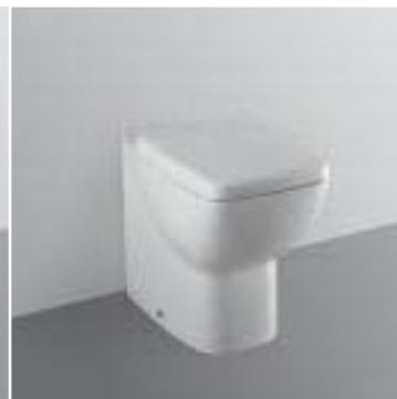
Vaso filo parete con scarico universale. Funziona con passo rapido e flussometro portata 1,2 l/sec - cassetta alta (scarico 9 l in 6 sec) o immurata (scarico 6 l in 4 sec). Il vaso è corredato di sedile, di fissaggi a pavimento e di raccordo di scarico a pavimento.
