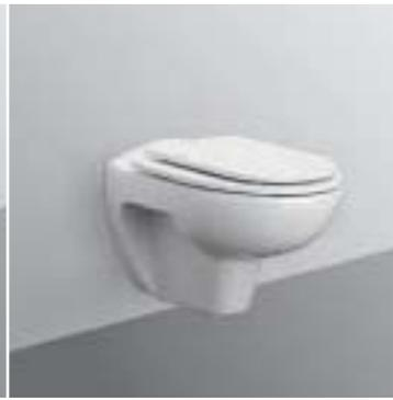
Vaso sospeso a cacciata con scarico a parete, funziona con passo rapido e flussometro - cassetta alta (scarico 9 l in 6 sec) o immurata (scarico 6 l in 4 sec). Per il fissaggio a parete è necessario utilizzare l'apposito sostegno metallico da incasso. Il sedile avvolgente per vaso - cerniere acciaio inox.
