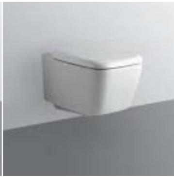
Vaso sospeso a cacciata con scarico a parete. Funziona con passo rapido e flussometro portata 1,2 l sec - cassetta alta (scarico 9 l in 6 sec) o immurata (scarico 6 l in 4 sec). Per il fissaggio a parete è necessario utilizzare l'apposito sostegno metallico. Il vaso è corredato di sedile.
