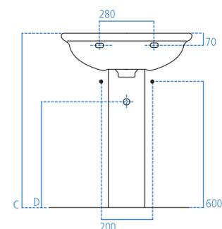
Lavabo disponibile in due versioni da 630 e 680 mm con foro centrale per la rubinetteria aperto e laterali diaframmati, vi si possono installare sia rubinetti monoforo che a tre fori. Il lavabo può essere completato con la semicolonna.
