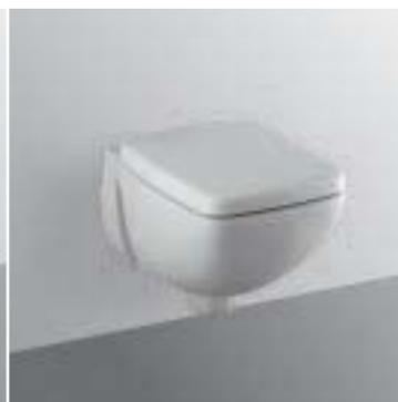
Vaso sospeso a cacciata con scarico a parete. Funziona con flussometro o passo rapido, con cassetta alta (scarico 9 l in 6 sec) o immurata (scarico 6 l in 4 sec). Il vaso è corredato di sedile. Per il fissaggio a parete è necessario utilizzare l'apposito sostegno metallico da incasso.
